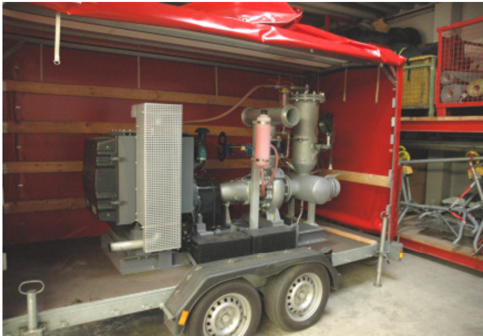
Leistungsstarke Hannibalpumpe im Anhänger
