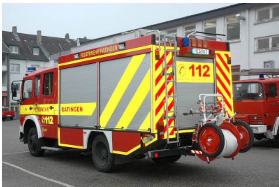
Retroreflektierende Folien erhöhen die Sicherheit der Einsatzkräfte
