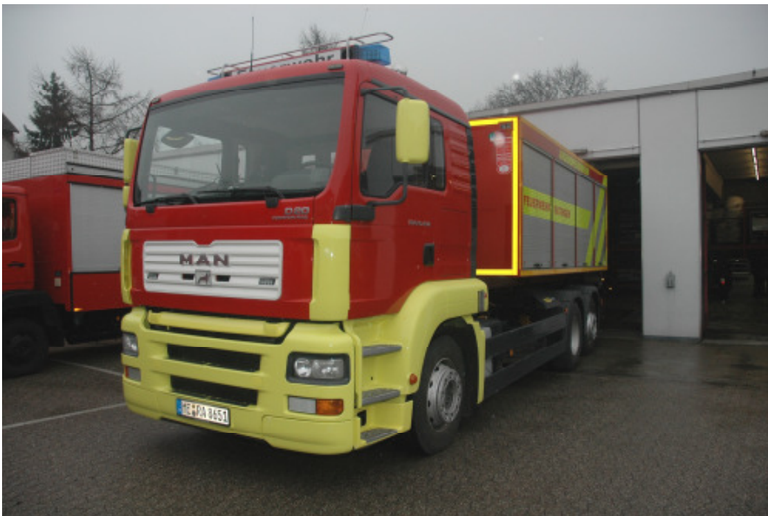
Wechseladerfahrzeug mit aufgesatteltem AB-Jugendfeuerwehr
