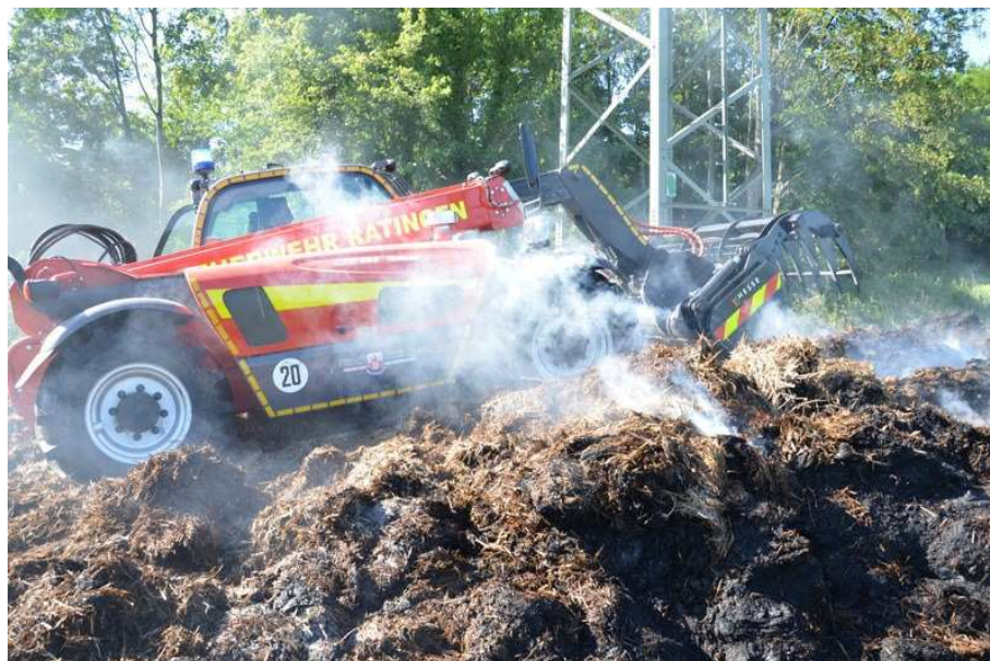
Teleskopradlader beim Auseinanderziehen von Mist“
