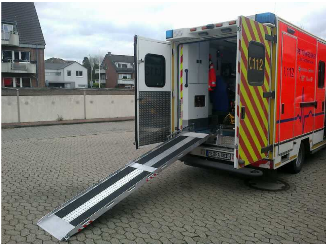
Die Heckladerampe des Rettungswagens im eingebauten Zustand
