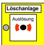
Handsteuereinrichtung für (Gas-)Löschanlagen
